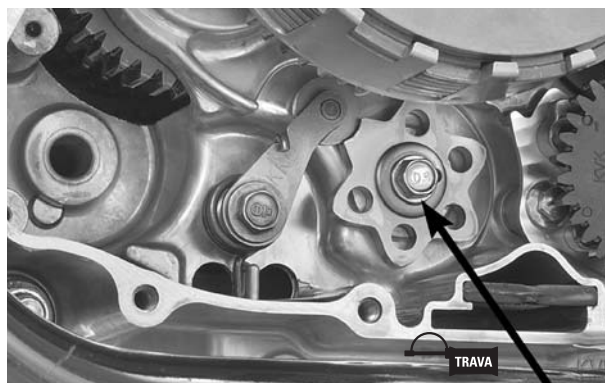
PARAFUSO DO EXCÊNTRICO SELETOR DE MARCHAS ANEL ELÁSTICO
