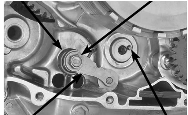
POSICIONADOR PINO GUIA POSICIONADOR EXCÊNTRICO SELETOR
