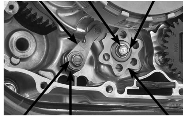
PARAFUSO MOLA/ARRUELA EXCÊNTRICO SELETOR ARRUELA/MOLA PARAFUSO
