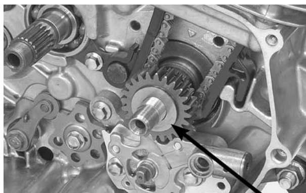
ARRUELA PORCA DA ENGRENAGEM MOTORA PRIMÁRIA
